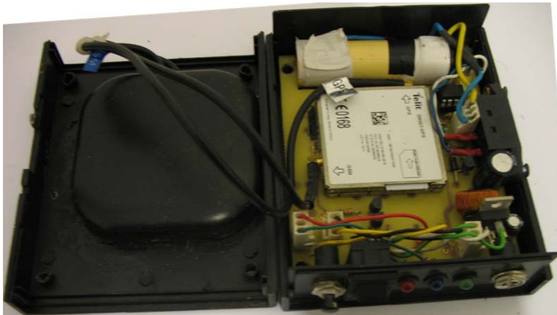
Slika 5. Unutrašnjost uređaja SMS pastira
