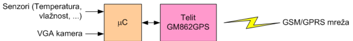
Slika 2. Blok šema modifikovane agrometeorološke stanice
