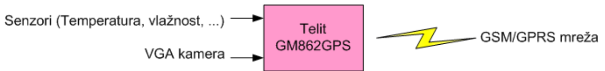
Slika 1. Blok šema agrometeorološke stanice
