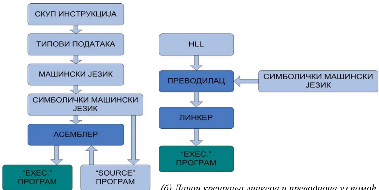
(а) Процес добијања извршне верзије програма на бази изворног симболичког кода
